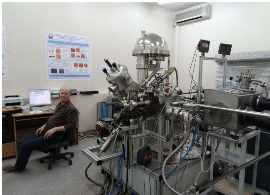
Рис.4. Спектрометр SPECS, состыкованный с системой загрузки образцов в инертной среде glove box
