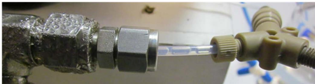
Рис. 2. Фотография смесителя и входной части реактора.
