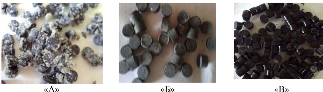
Рисунок 1 - Внешний вид катализатора НИАП-07-07 после обработки 25%-ным водным раствором поташа (А) с последующей паровой обработкой (Б) и после промывки горячим паровым конденсатом (В)
