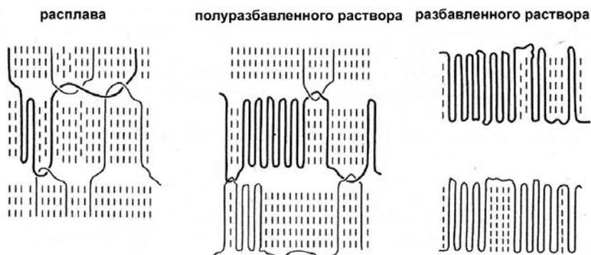
Рис. 1. Схема молекулярных зацеплений в СВМПЭ [2].
